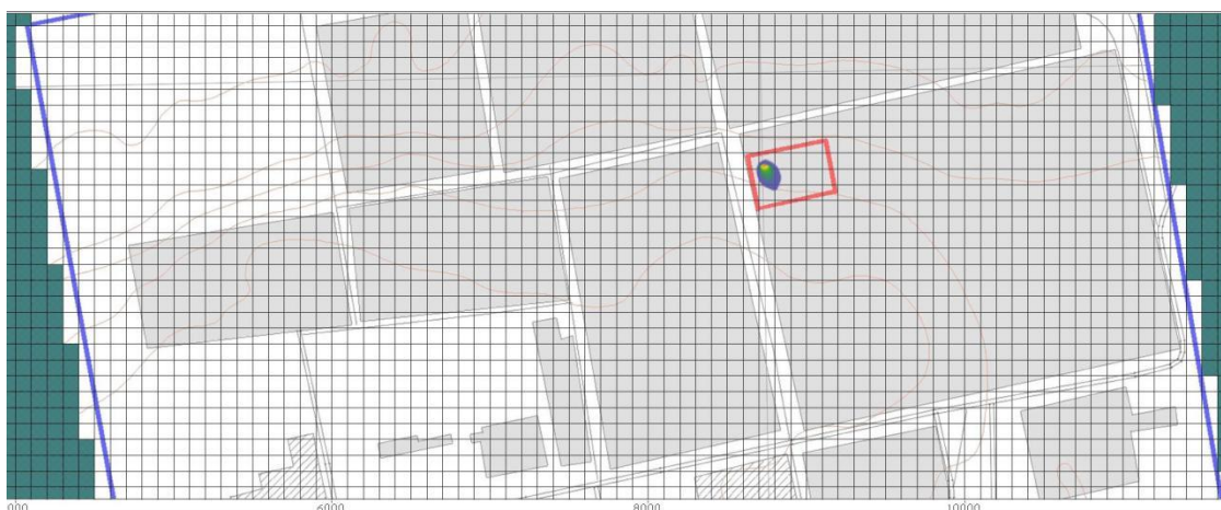
图 5.2-14 非正常状况下收集池渗漏 100d 动植物油污染晕扩散图
